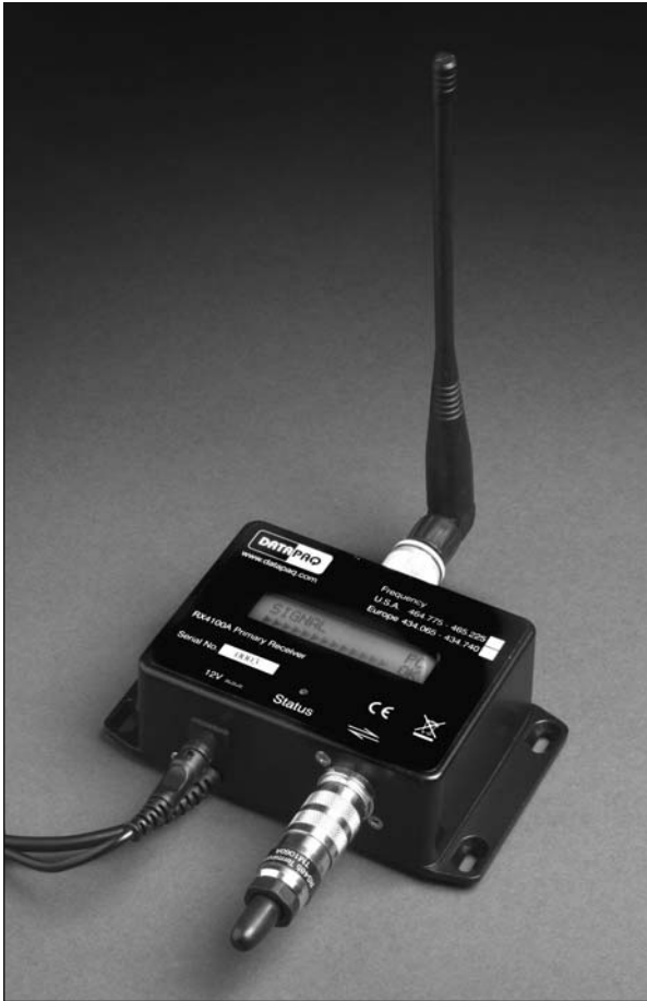
TM21 主接收器: 螺線管 (「鞭狀」) 天線接在上側, 左下側為 USB 連線, 右下側為插入從接收器插座的 RS485 終端電阻。
