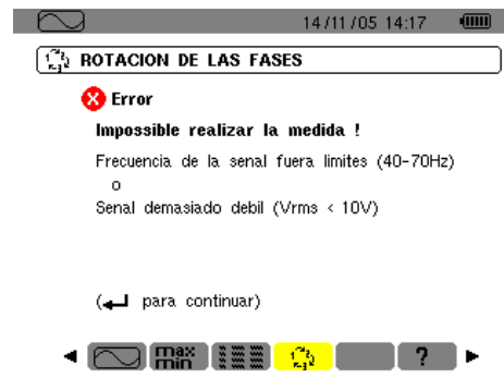
Figura 29: frecuencia fuera de límite o señal demasiado débil.
