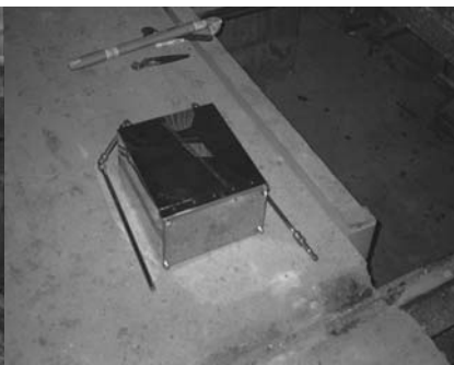
Punti di entrata e troppopieno portati con tubi sul davanti del carrello del forno.
