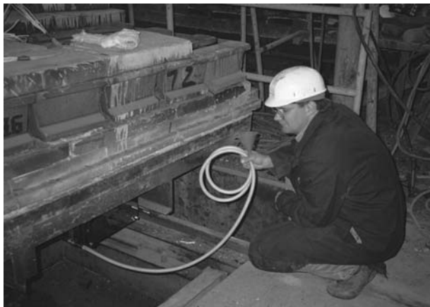
Riempimento della barriera termica prima di una prova.
