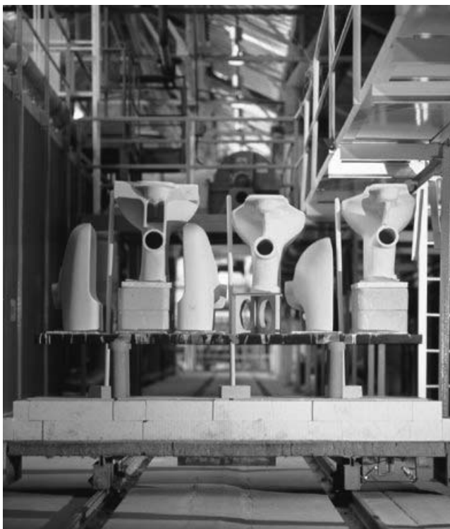
Carrello caricato con idrosanitari e pronto a partire.
