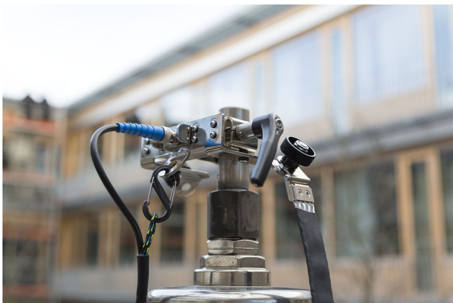
Joonis 4-7: Sinise koaksiaalkaabli ühendamine läbiviikisolaatori klambri, kasutades mehhanismi, mis vähendab pinget BNC kilbile
