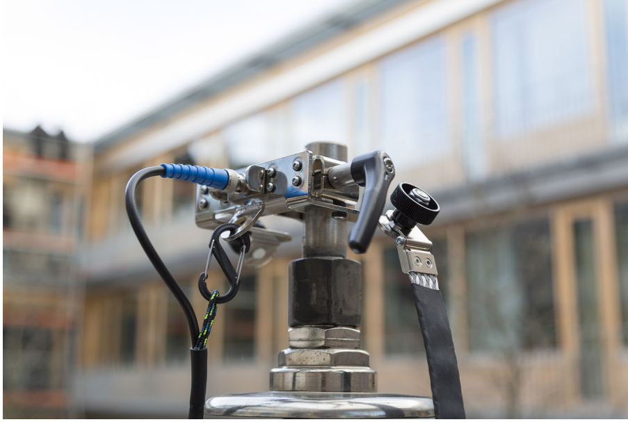
Şekil 5-7: BNC blendajındaki basıncı tahliye etmek için mekanizmayı kullanarak mavi koaksiyel kabloyu buşing klampına bağlama
