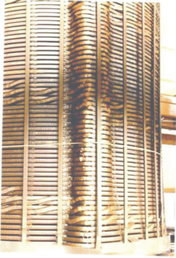
řekil 3-3: Dairesel bobin deformasyonu
