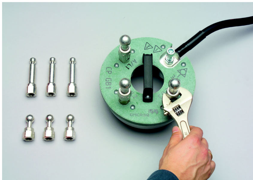
Figure 2-5: Serrage des vis de terre du CP GB1
