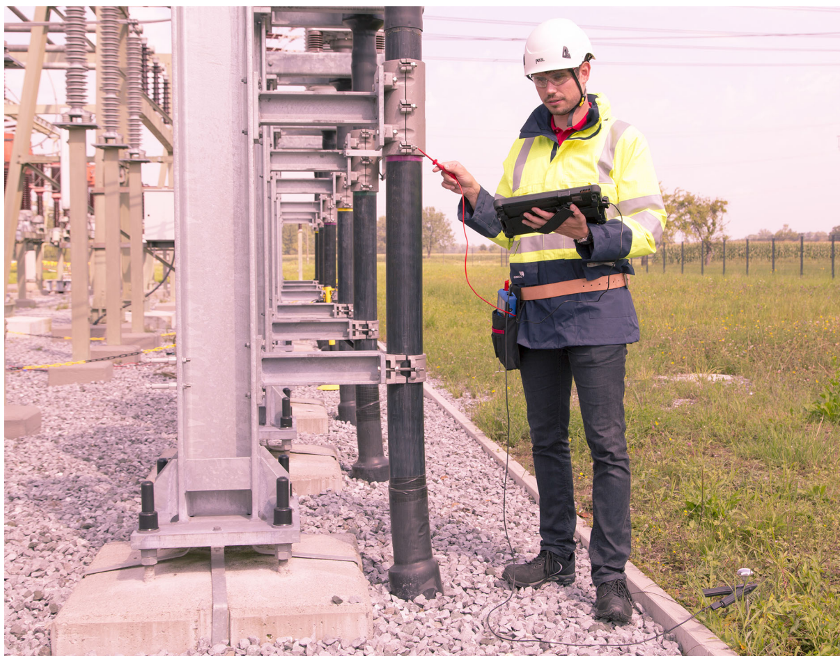
Figure 5-26: Mesure de la tension de contact avec PTM (tablette) selon la norme IEEE 81
