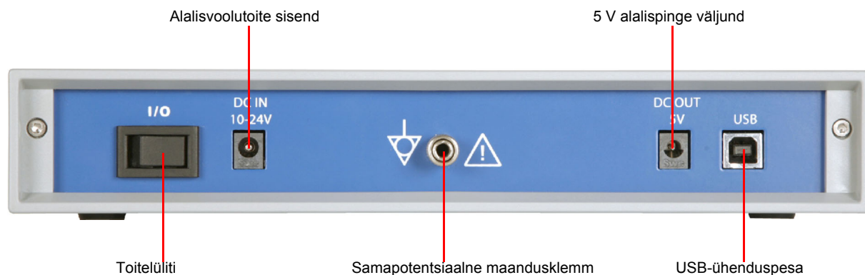
Joonis 3-2. Seadme DIRANA tagantvaade
