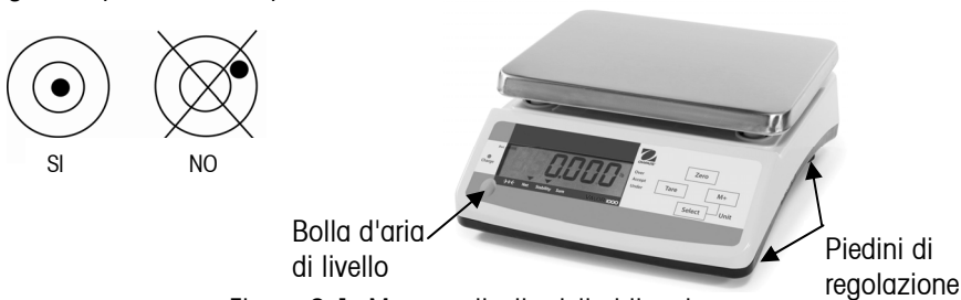
Figura 2-1. Messa a livello della bilancia.
