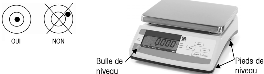
Figure 2-1. Mise à niveau de la balance.
