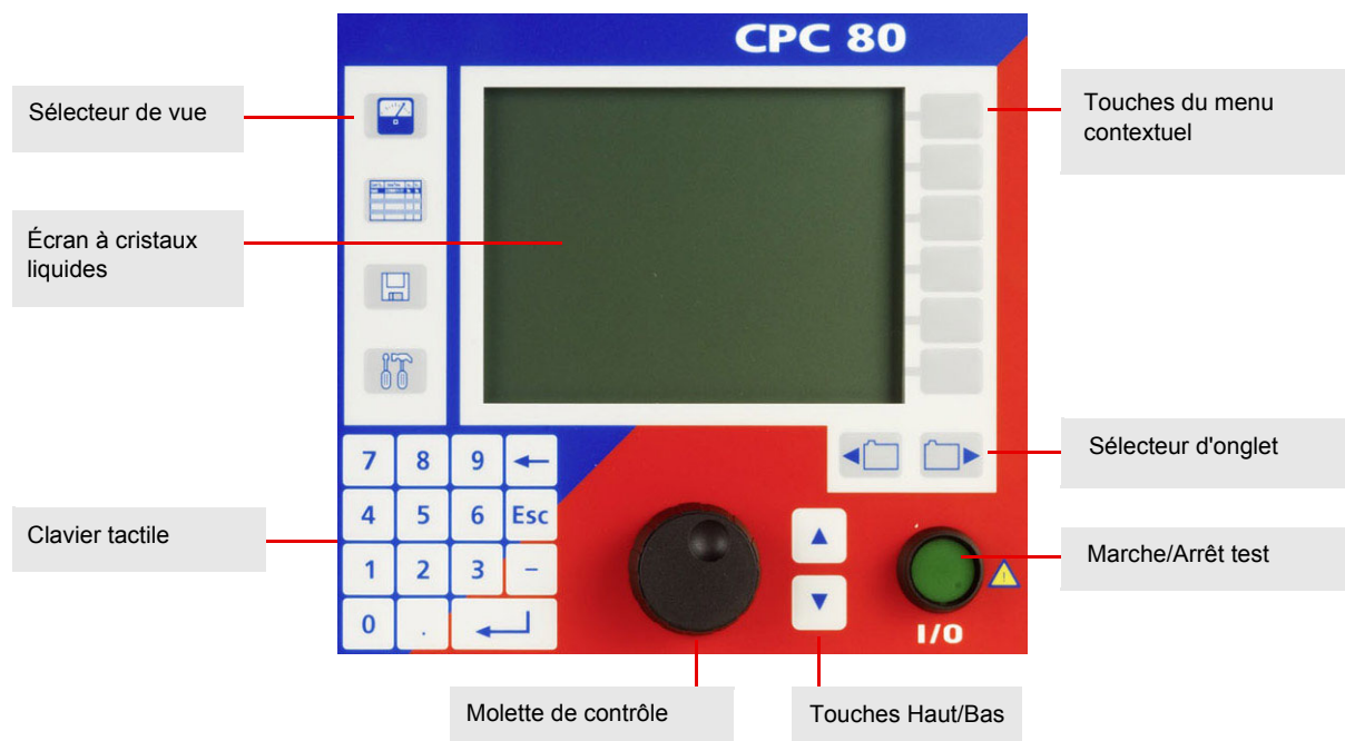
Figure 3-2: ePC intégré du CPC 80 , vue d'ensemble des composants
