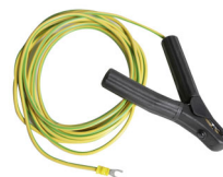
Cabo de aterramento (GR/YE) com 6 m/20 pés, 6 mm 2 com braçadeiras
