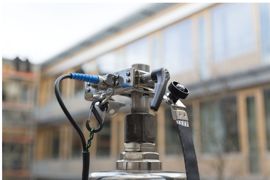
Slika 4-7: Priključivanje plavog koaksijalnog kabela na priključnu stezaljku uz upotrebu mehanizma za smanjivanje opterećenja štitnika BNC kabela
