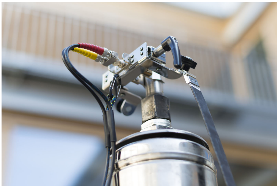
Slika 4-4: Priklučivanje žutog i crvenog koaksijalnog kabela na priključnu stezaljku uz upotrebu mehanizma za smanjivanje opterećenja štitnika BNC kabela
