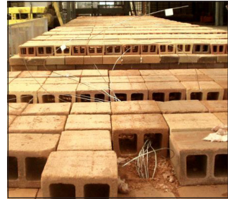
Alimentación de termocuplas a través de los ladrillos refractarios sobre la base del carro del horno hacia la barrera térmica debajo.
