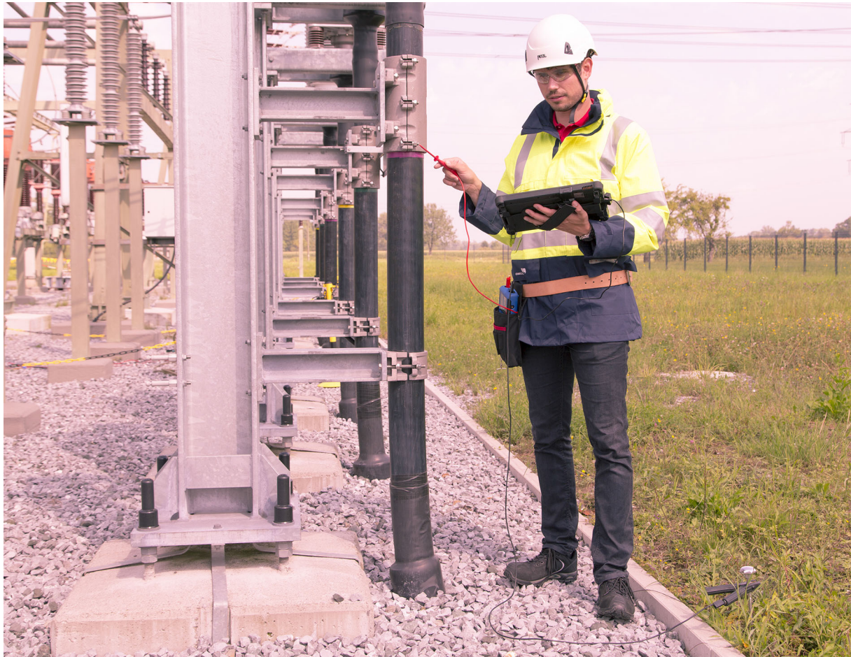
Figure 8-12: Mesure de la tension de contact avec PTM (tablette) selon la norme IEEE 81
