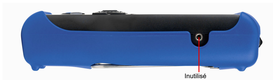
Figure 3-5: Connecteurs latéraux droits du HGT1
