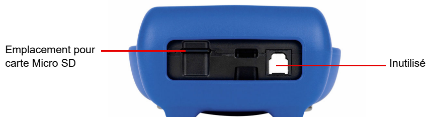
Figure 3-3: Connecteurs inférieurs du HGT1
