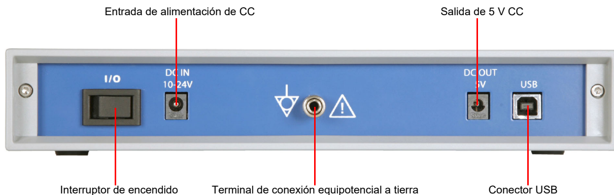
Figura 3-2: Vista posterior de DIRANA
