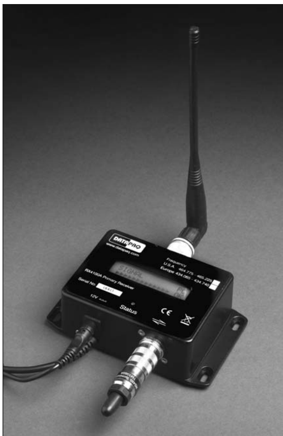
TM21一次受信機:ヘリカルコイル (ホイップ) アンテナ (上側)、USB 接続ケーブル (左下)、二次受信機ソケットに取り付けてある RS485 ターミネータ (右下)。
