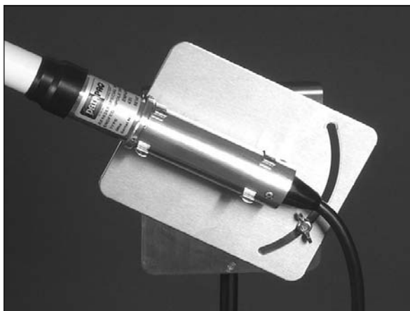
Unity-gain end-feed アンテナがそのスタンドに正しく取り付けられている様子。
