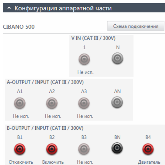
Рис. 17-28: Конфигурация аппаратной части для испытания «Ток двигателя»
