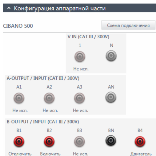
Рис. 17-11: Конфигурация аппаратной части для испытания «Ток двигателя»
