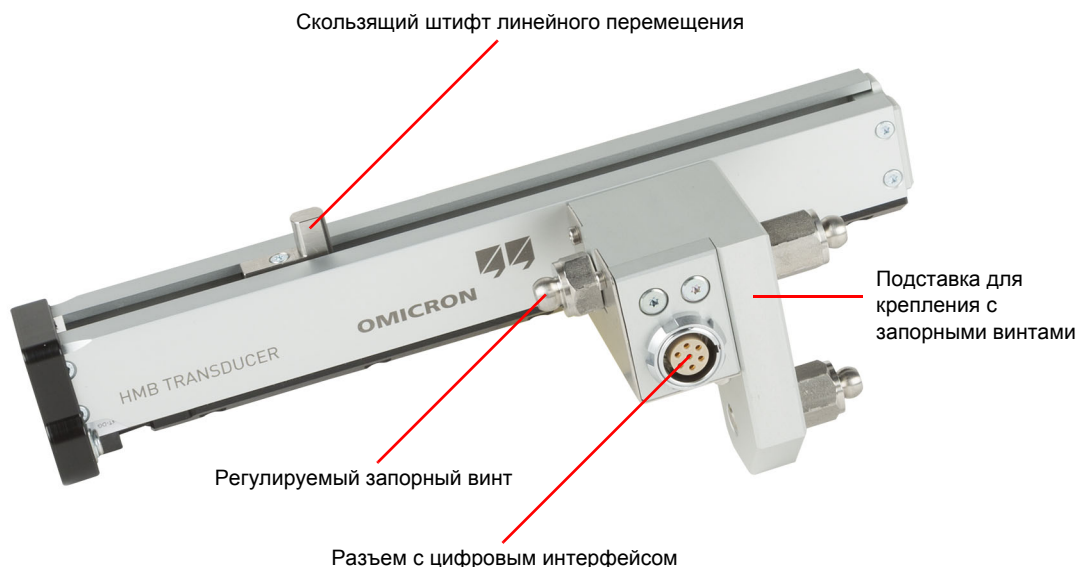
Рис. 19-16: Преобразователь для выключателей с приводным механизмом типа ABB HMB
