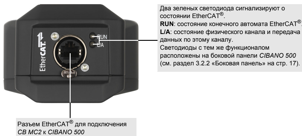
Рис. 22-2: Вид модуля CB MC2 снизу
