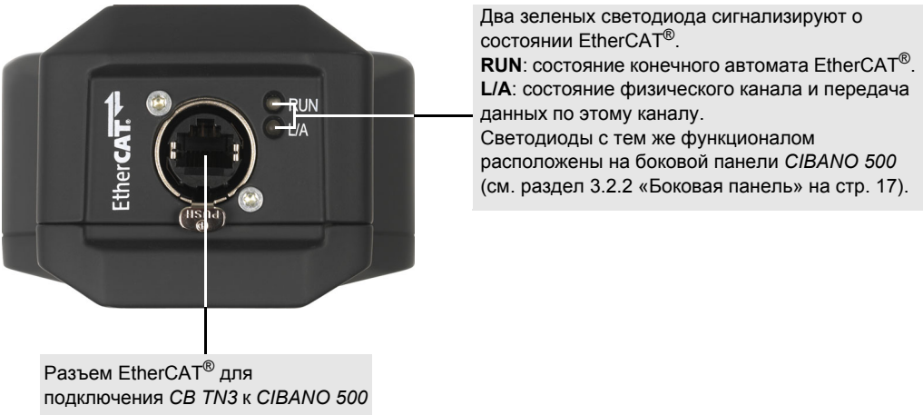
Рис. 22-4: Вид модуля CB TN3 снизу
