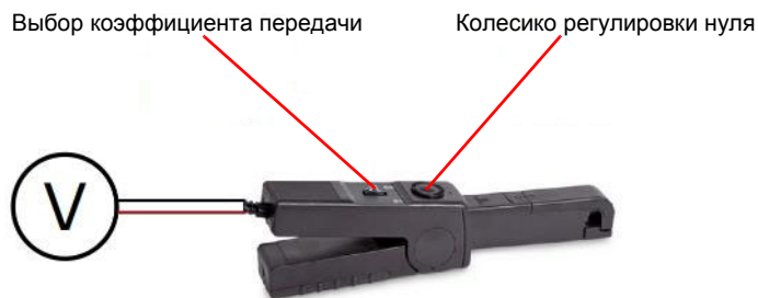
Рис. 18-4: Элементы настройки OMICRON токоизмерительных зажимов
