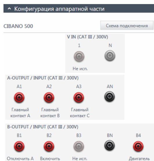
Рис. 17-6: Конфигурация аппаратной части для испытания «Определение времени срабатывания»
