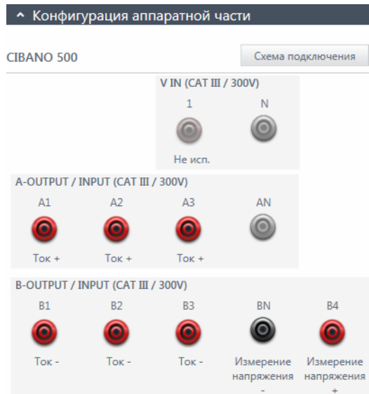
Рис. 17-47: Конфигурация аппаратной части для испытания «Размагничивание»
