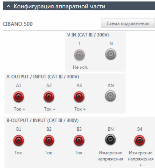
Рис. 17-4: Конфигурация аппаратной части для испытания «Переходное сопротивление»
