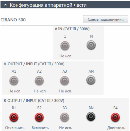
Рис. 17-44: Конфигурация аппаратной части для испытания «Ток двигателя»
