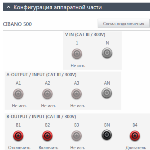
Рис. 17-43: Конфигурация аппаратной части для испытания «Мин. напряжение срабатывания»
