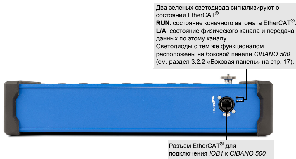
Рис. 22-8: Вид модуля IOB1снизу
