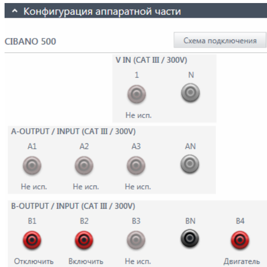
Рис. 17-10: Конфигурация аппаратной части для испытания «Мин. напряжение срабатывания»
