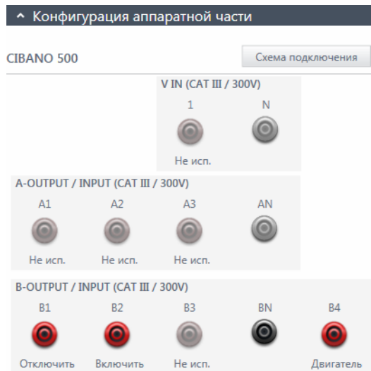
Рис. 17-27: Конфигурация аппаратной части для испытания «Мин. напряжение срабатывания»
