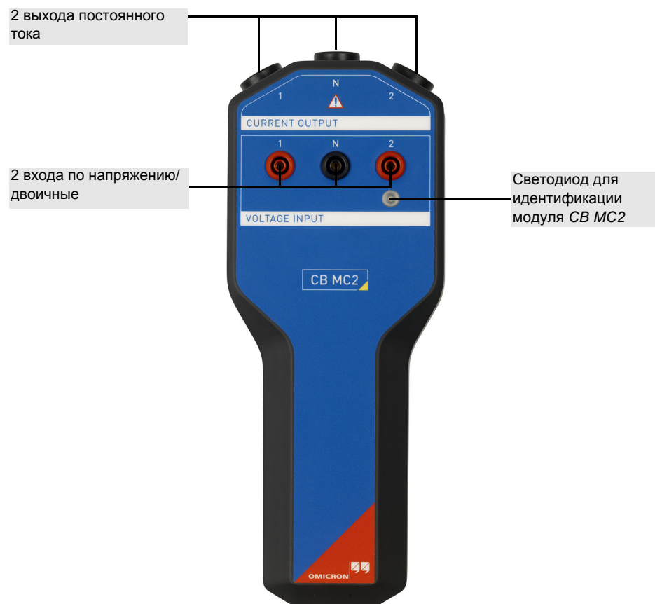
Рис. 22-1: Вид модуля СВ MC2 спереди
