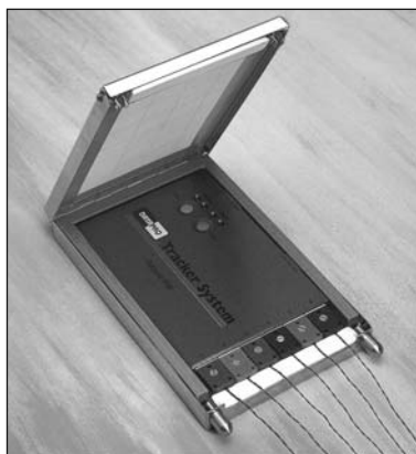
Registratore inserito nella barriera termica.
