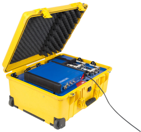
Рис. 4-2: Подключите комплект FRANEO 800 к компьютеру с помощью кабеля A/B USB 2.0
