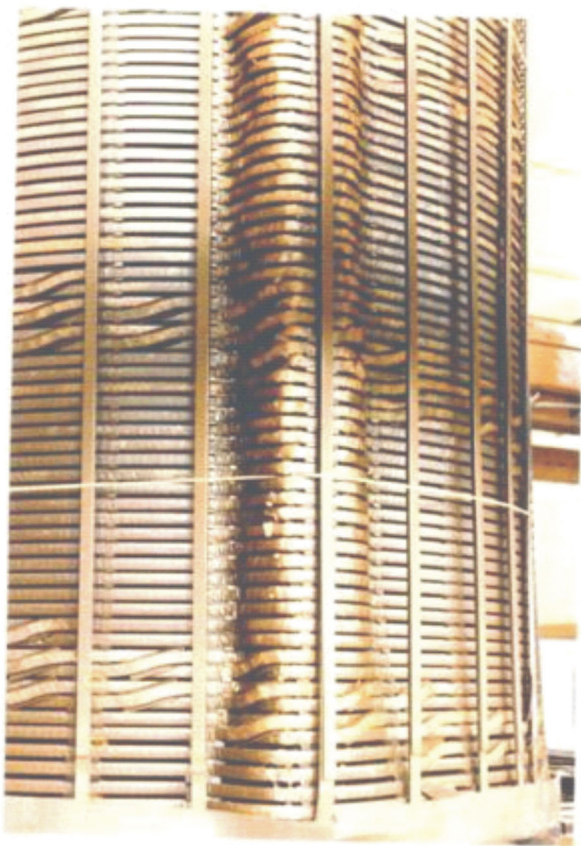
Рис. 3-3: Радиальная деформация катушек
