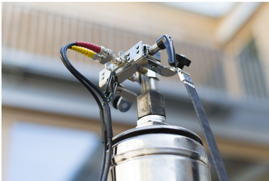
Рис. 4-4: Подключение желтого и красного коаксиальных кабелей к зажимам высоковольтного ввода с поддержкой экрана BNC
