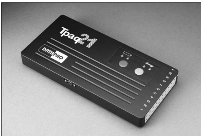
10-Kanal-Logger vom Typ Tpaq21 mit Leuchtdioden und Start-/Stopptaste (oben), Kommunikationsanschluss (vorne) und Anschlüsse für Thermoelement und Sendeantenne (rechts).
