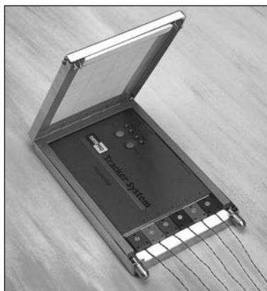
Registrador colocado en su barrera térmica.
