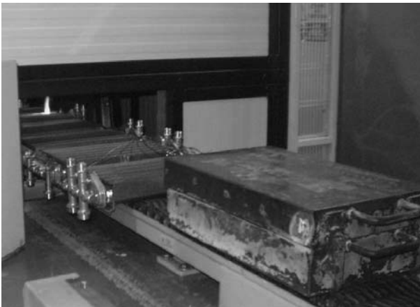
プローブがテストピースに装着された耐熱ケース
