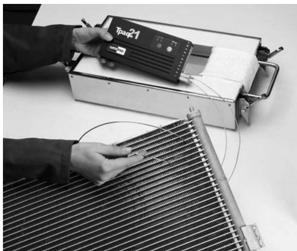
ラジエータテストピースに装着されている熱電対プローブ
