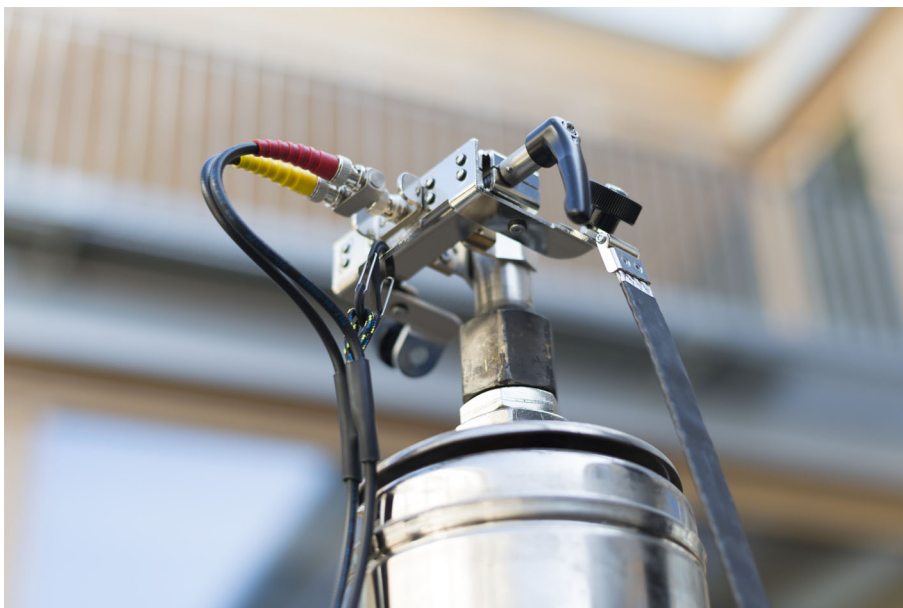
图 4-4：使用操作机构松开 BNC 屏蔽装置，将黄色和红色同轴电缆连接到套管夹上
