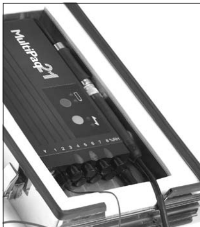
Boîtier électronique placé dans le dispositif de retenue de la sonde d'humidité du bouclier thermique.
