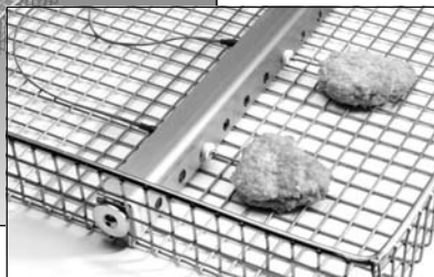
Plateau avec bouclier thermique en place, avec morceaux de poulet sondés.
