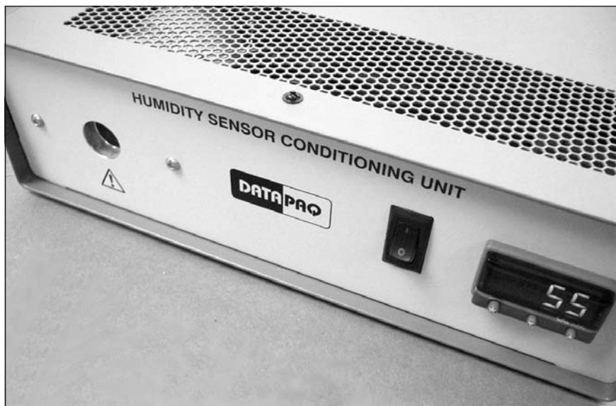
Dispositif de mise en condition des capteurs d'humidité, CS3050.
