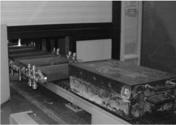
Barriera per forno metallurgico con sonde collegate a un pezzo di prova.
