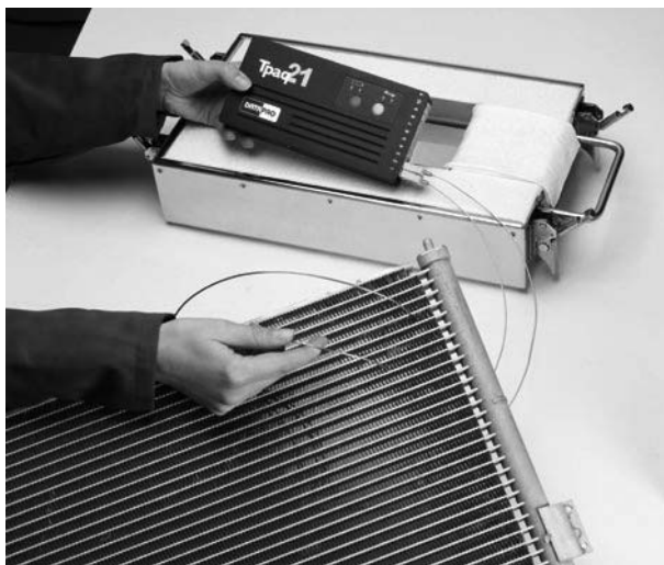
Fissaggio delle sonde a termocoppia a un radiatore di prova.
