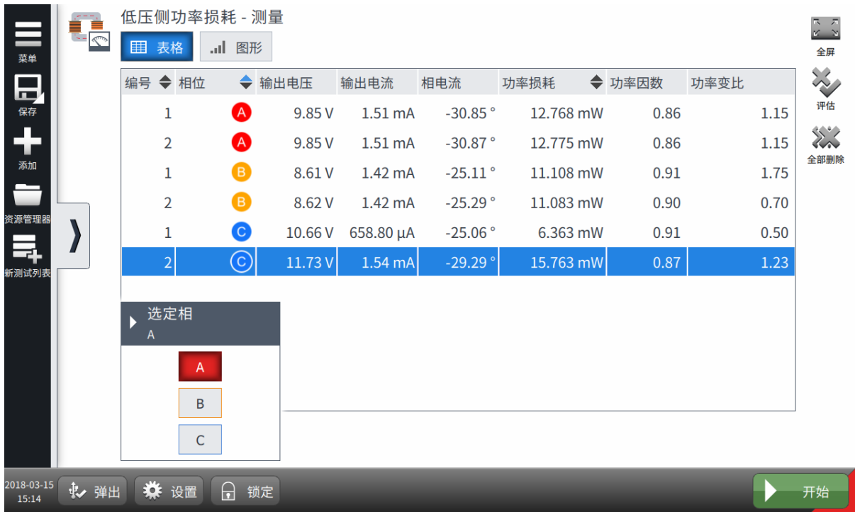
图 8-18：低电压测试的功率损耗 - 测量视图
