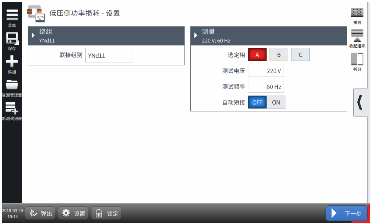
图 8-17：低电压测试的功率损耗 - 设置视图
