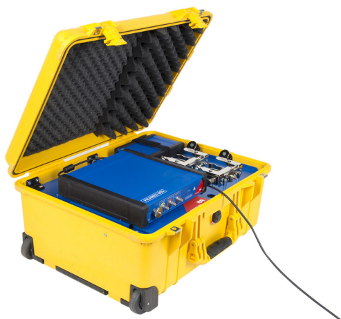
图 5-2：使用随附的 USB 2.0 A/B 连接线将 FRANEO 800 连接至电脑。
