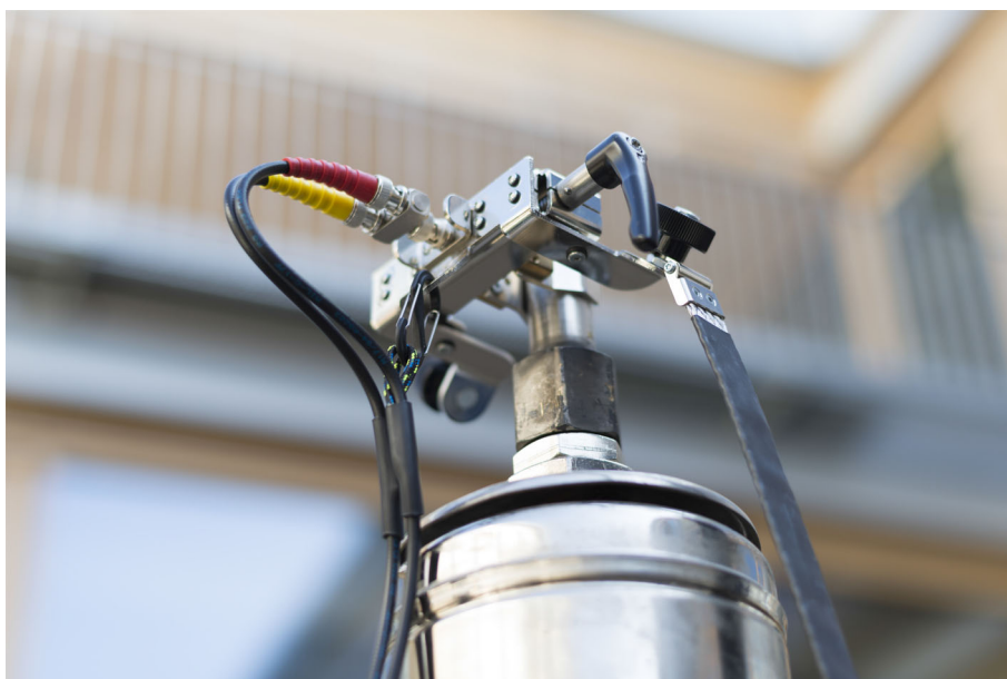
图 5-4：使用操作机构松开 BNC 屏蔽装置，将黄色和红色同轴电缆连接到套管夹上
