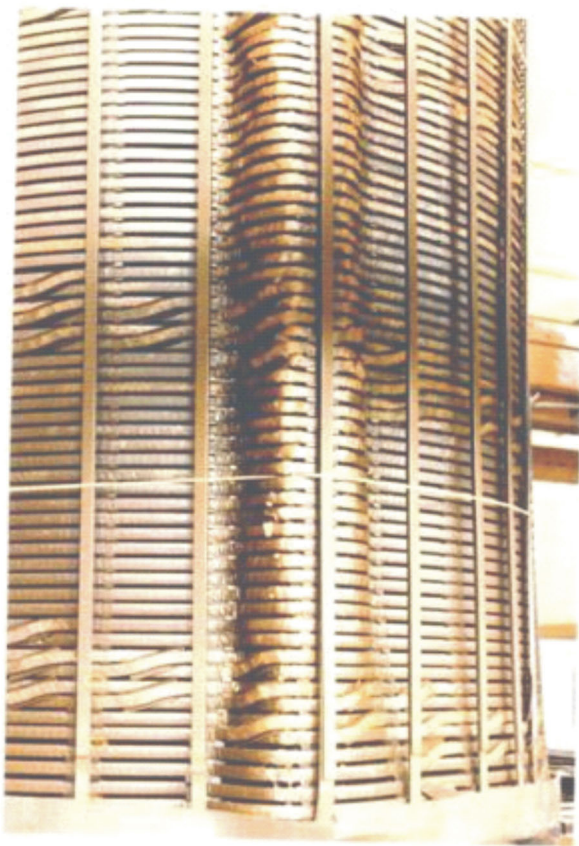
图 3-3：线圈径向变形
