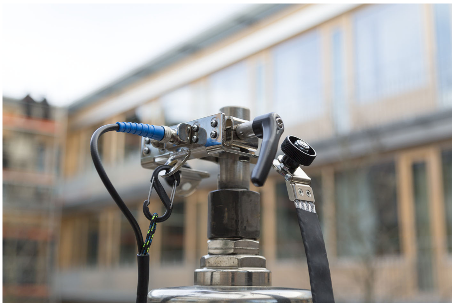
4-7. ábra: A kék koaxiális kábel csatlakoztatása a perselybilincshez a BNC-védőegység tehermentesítésére szolgáló mechanizmussal
