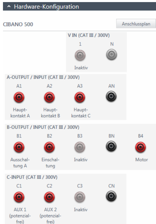
Abbildung 17-8: Hardware-Konfiguration für die Prüfung des Zeitverhaltens
