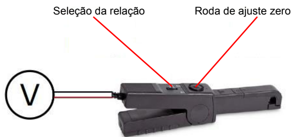
Figura 18-4: Controles de ajuste dos grampos de corrente da OMICRON
