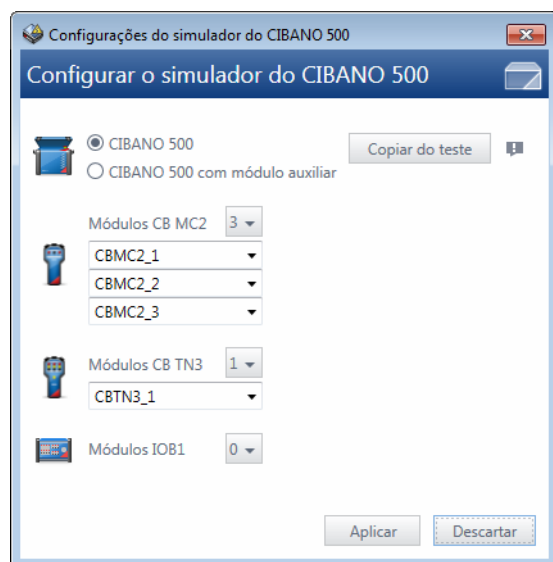
Figura 7-16: Caixa de diálogo Configurações do simulador do CIBANO 500 .
