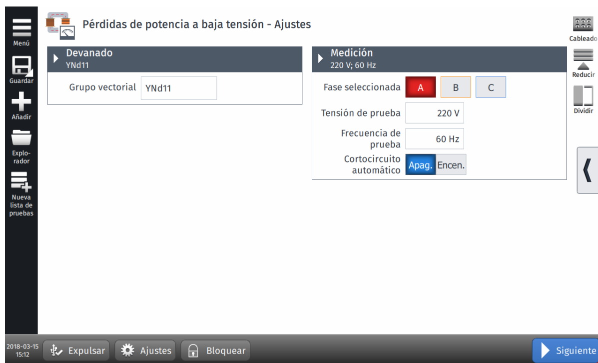
Figura 8-17: Prueba de pérdidas de potencia a baja tensión – Vista de ajustes
