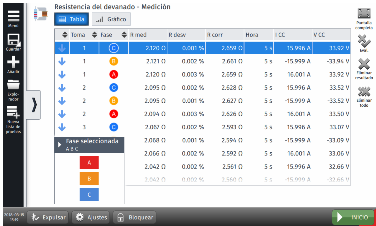
Figura 8-6: Prueba de resistencia del devanado – Vista de medición
