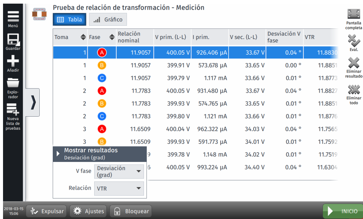
Figura 8-4: Prueba de relación de transformación – Vista Medición con resultados
