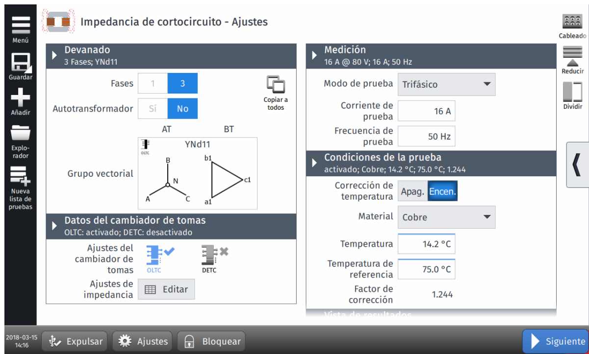
Figura 8-9: Prueba de impedancia de cortocircuito – Vista ajustes
