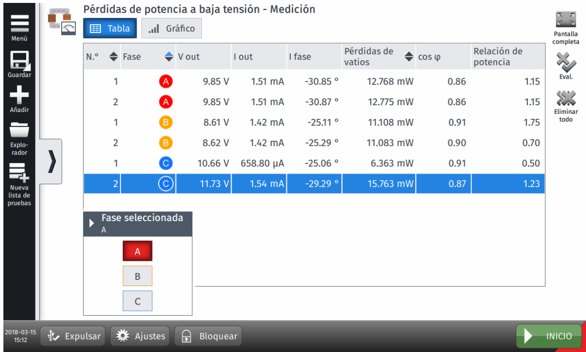
Figura 8-18: Prueba de pérdidas de potencia a baja tensión – Vista de medición
