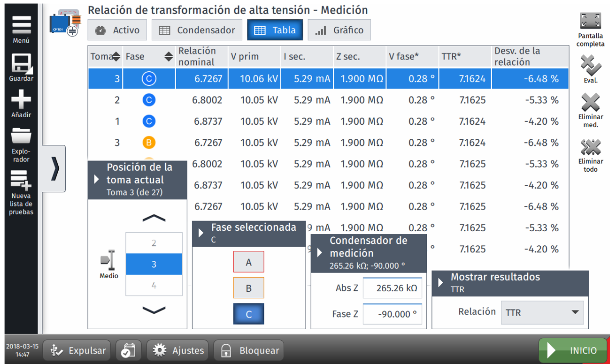
Figura 8-16: Prueba de relación de transformación de alta tensión – Vista Medición con resultados
