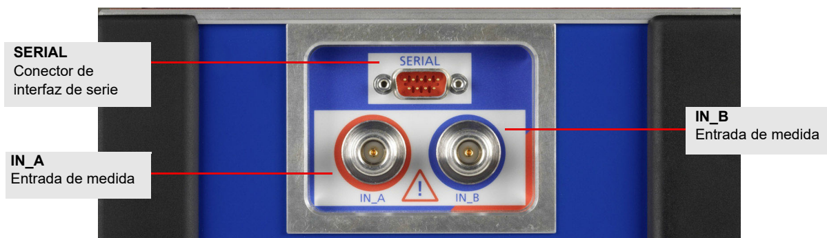
Figura 3-4: Vista lateral derecha del CP TD1
