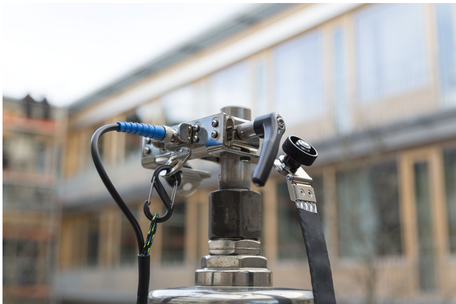
Attēls 4-7: Savienojiet zilo koaksiālo kabeli ar iemavas spaili, izmantojot BNC ekranējuma stiepes atslodzes mehānismu
