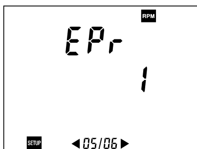
Figure 53 : Affichage du paramètre relatif au nombre d'événement par tour du signal tachymétrique.
