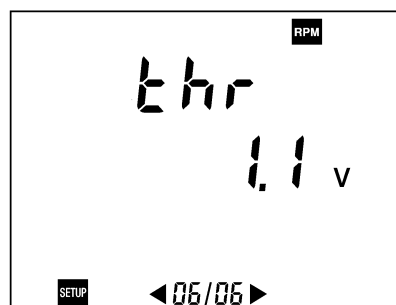
Figure 54 : Affichage du paramètre relatif à la tension de seuil du capteur tachymétrique.
