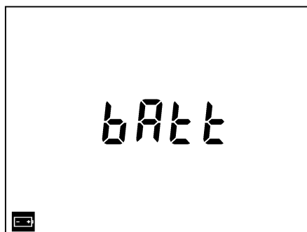
Figure 5 : L'indication de batterie faible nécessitant un remplacement.
