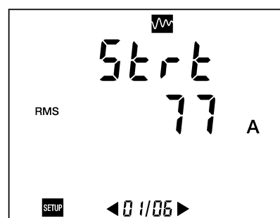
Figure 47 : Affichage du paramètre relatif au courant de départ.
