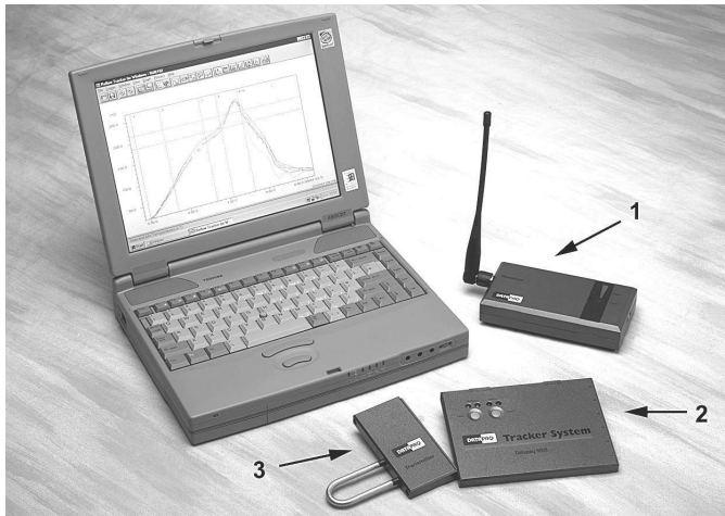
Funktelemetriemodule für das Reflow-Tracker-System. 1: Empfänger 2: Datenlogger vom Typ Datapaq 9000 3: Sender
