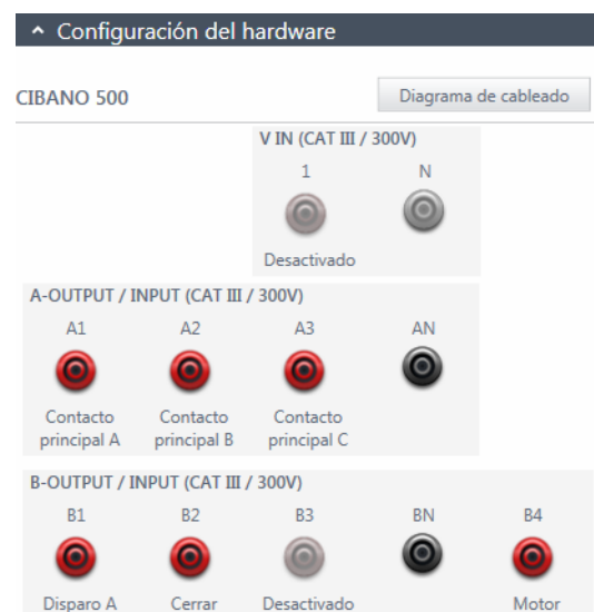
Figura 17-2: Configuración del hardware de la unidad de prueba para un grupo de prueba
