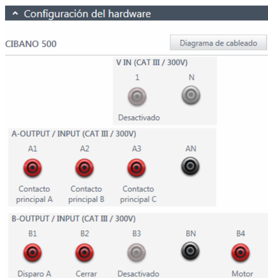
Figura 17-6: Configuración del hardware de la prueba de sincronismo
