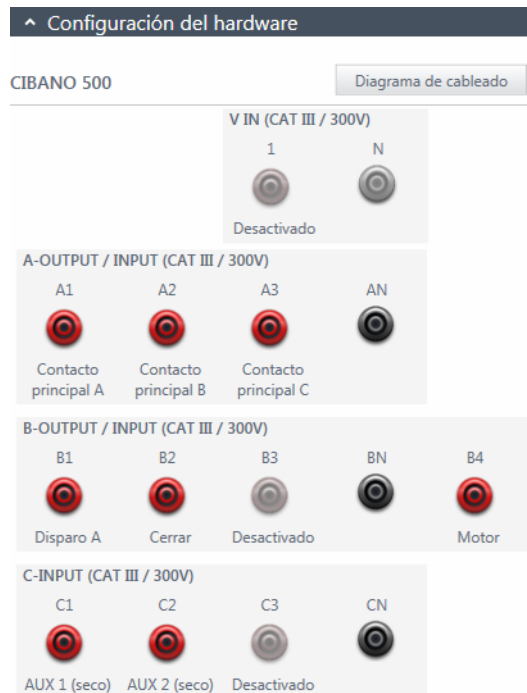
Figura 17-8: Configuración del hardware de la prueba de sincronismo
