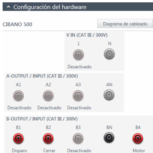
Figura 17-28: Configuración del hardware de la prueba de corriente del motor
