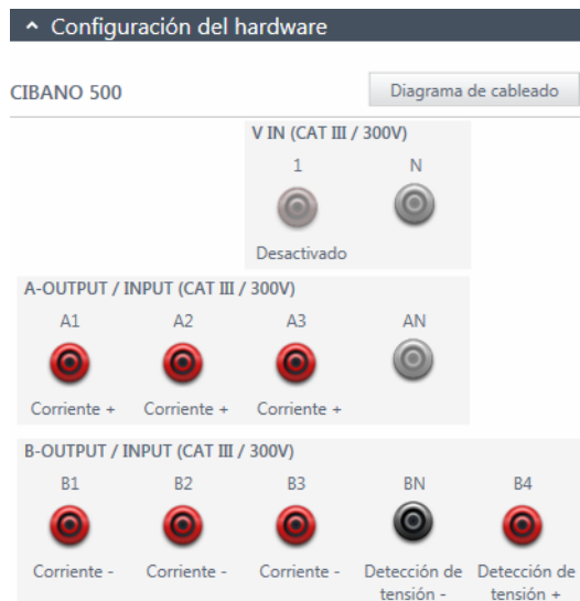
Figura 17-47: Configuración del hardware de la desmagnetización
