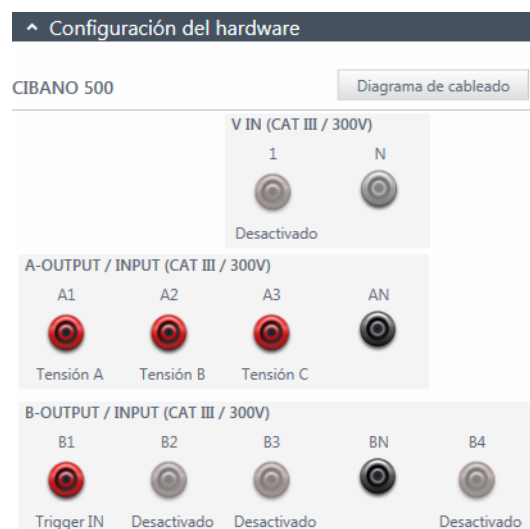
Figura 18-1: Configuración del hardware de la prueba de tiempos (en servicio)
