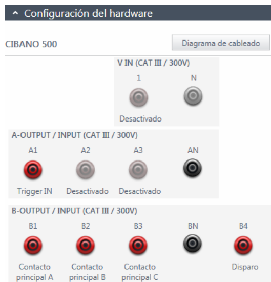
Figura 18-2: Configuración del hardware de la prueba del primer disparo
