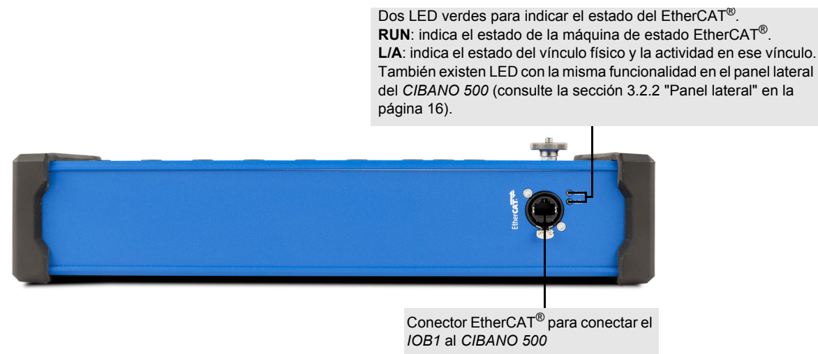
Figura 22-8: Vista inferior del módulo IOB1
