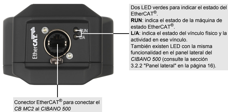
Figura 22-2: Vista inferior del módulo CB MC2
