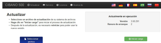
Figura 20-3: Actualización del software integrado del CIBANO 500
