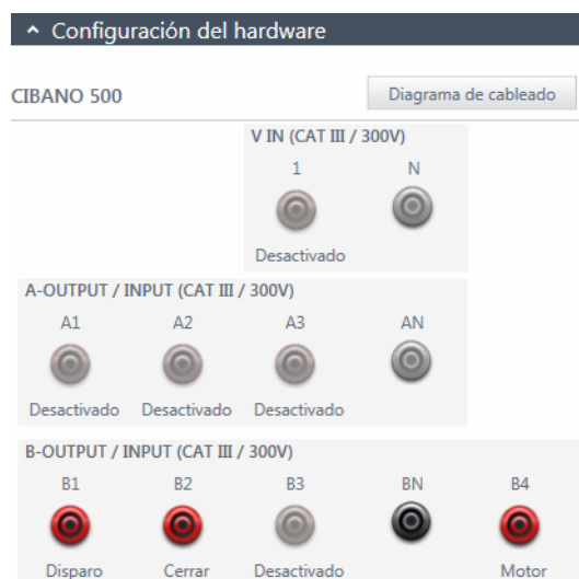
Figura 17-10: Configuración del hardware de la prueba de tensión mínima de operación
