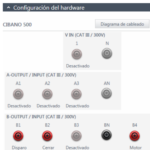
Figura 17-11: Configuración del hardware de la prueba de corriente del motor
