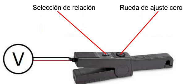
Figura 18-4: Controles de ajuste de las pinzas de corriente OMICRON.
