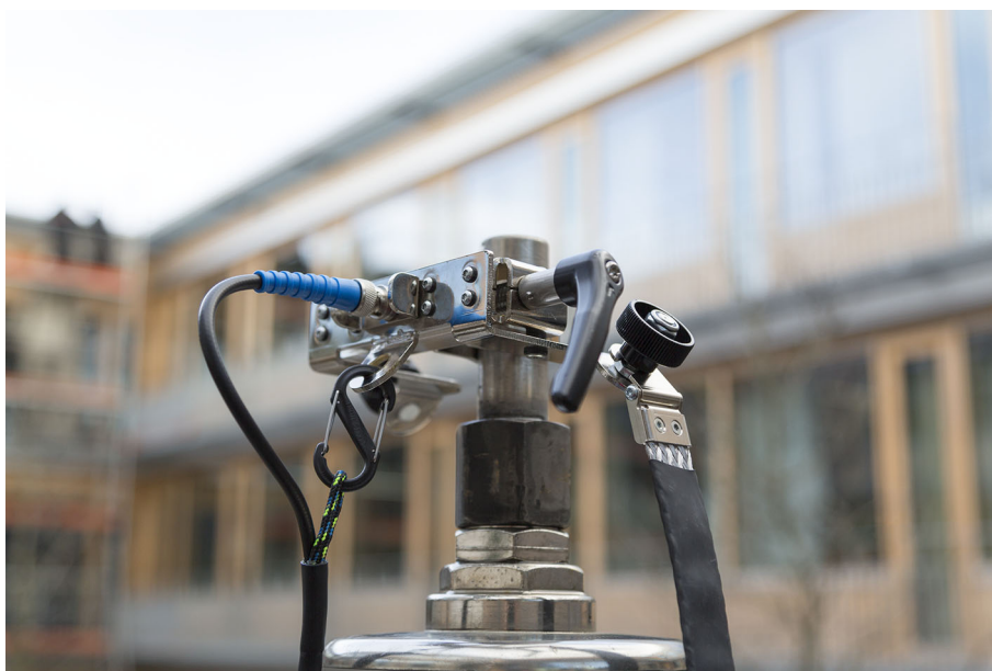
Afbeelding 4-7: De blauwe coaxkabel aansluiten op de busklem met behulp van het mechanisme voor het verlichten van de druk op het BNC-schild
