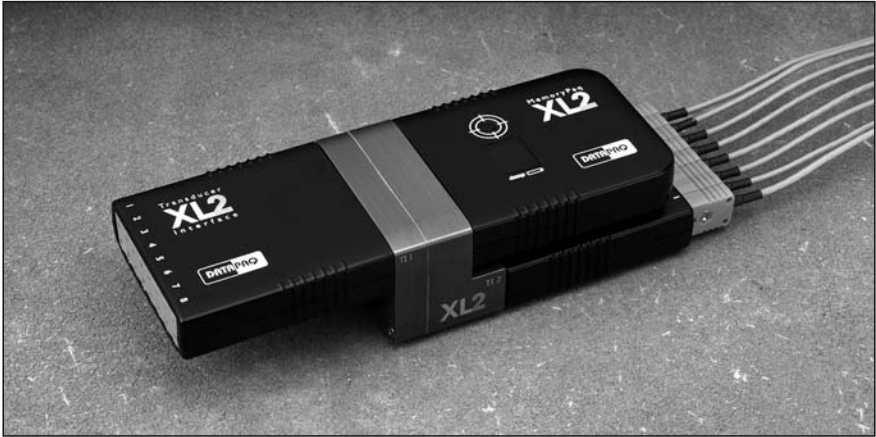
XL2 记录器：MemoryPaq（右上）、双接口块（中）、两个转接口口（左和右下）
