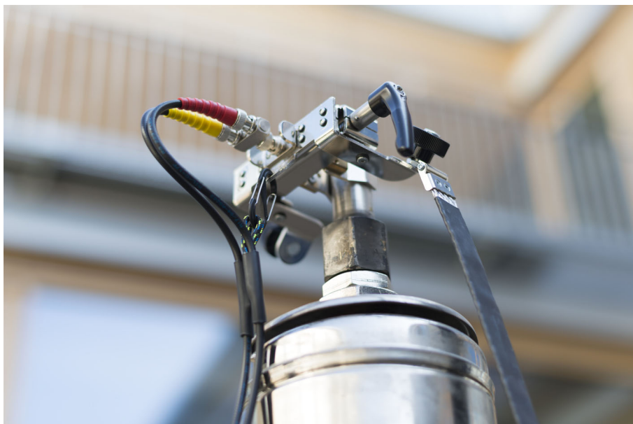
Obrázek 4-4: Připojení žlutého a červeného koaxiálního kabelu k průchodkové svorce s použitím mechanismu na odlehčení namáhání pouzdra konektoru BNC
