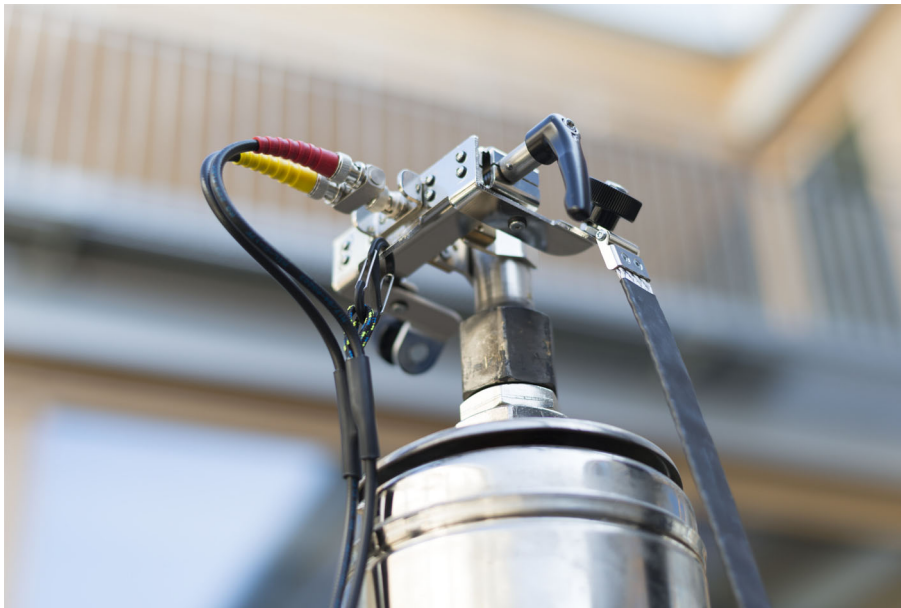
Abbildung 4-4: Anschließen des gelben und roten Koaxkabels an der Durchführungsklemme (mit Vorrichtung zur Zugentlastung des BNC-Schirms)
