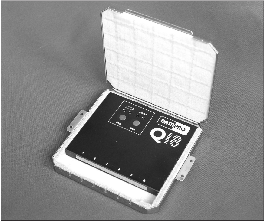
Q18 データロガー（TB7400 耐熱ケースにあり、反射防止コーティングプロセス用）。
