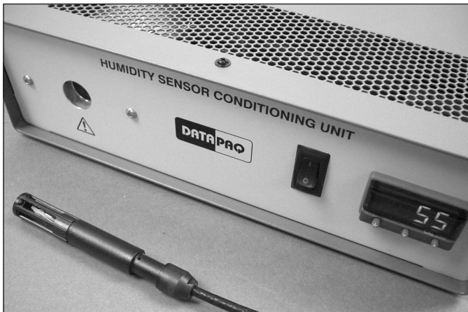
Dispositif de conditionnement du détecteur d'humidité, CS3050.
